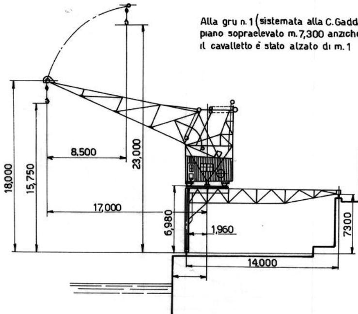
Alla gru n. 1 (sistemata alla C. Gadda, essendo il piano sopraelevato m. 7,300 anziché m. 6,300) il cavalletto è stato alzato di m. 1
